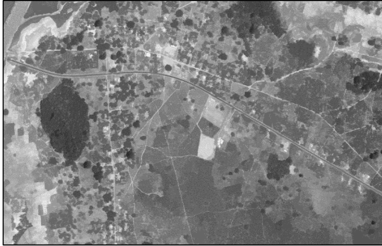
Figure 4. Fermeture par reconstruction de l'Image Google Earth de Baïla à l'aide d'un disque de taille 9
