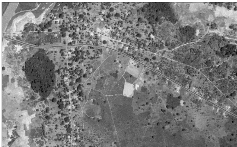
Figure 2. Fermeture par reconstruction de l'Image Google Earth de Baïla à l'aide d'un disque de taille 3
